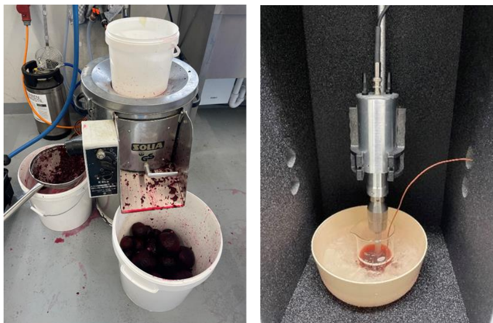
Slika 12. Postupak odvajanja kore kao nusproizvoda (lijevo) i pripremljeni uzorak kore cikle postavljen u kućište ultrazvučnog aparata (desno) (izvor: vlastita arhiva)
